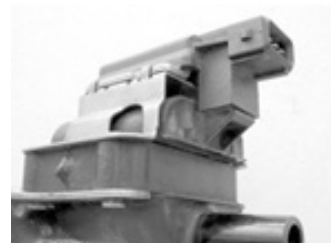
Bobina Bosch F 000 ZS0 104 Módulo de ignição integrado.
